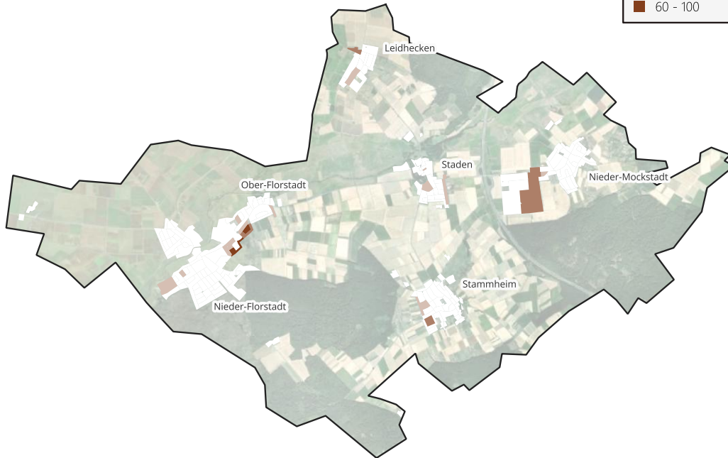
Abbildung 28: Anteil von Flüssiggas am Wärmebedarf auf Baublockebene
