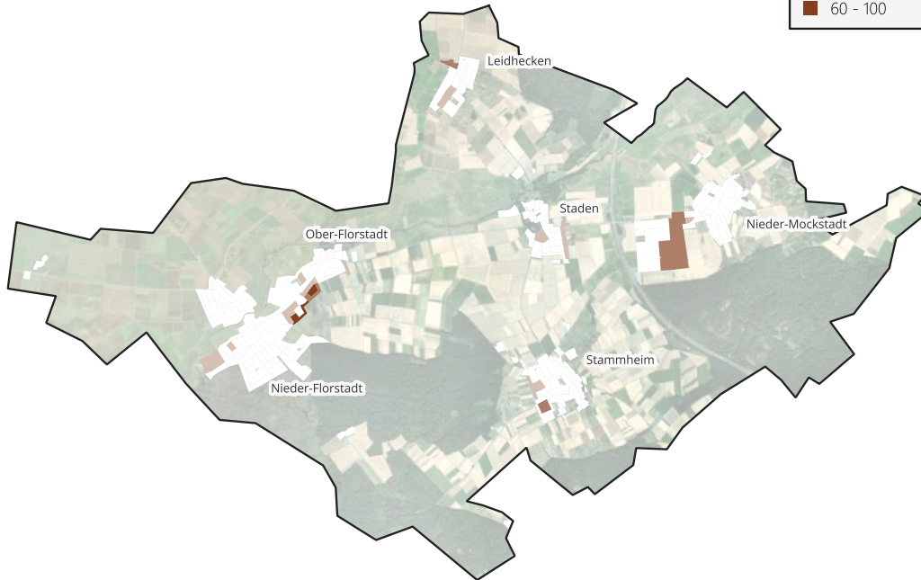
Abbildung 28: Anteil von Flüssigas am Wärmebedarf auf Baublockebene
